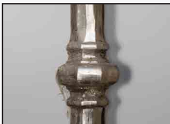
Esempio di inquinamento da Agenti esterni quali Pulviscolo e smog Example of a stainless steel picket polluted by external agents like dust and smog
