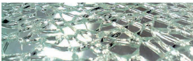
In caso di rottura il vetro temprato produce piccoli frammenti non taglienti. In case of breakage, tempered glass implies little fragments that are not sharp.
